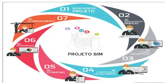
**Figura 2.** As Dimensões do BIM[16].
