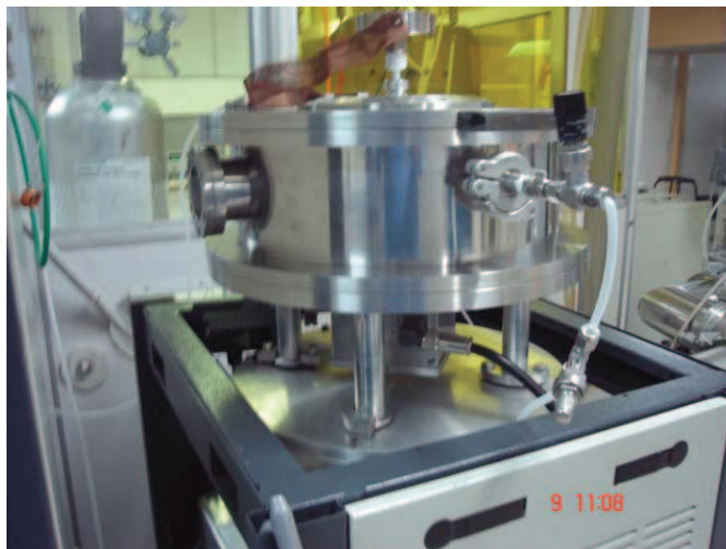
Figura 6. Reator de plasma utilizado nos processos de corrosão.
